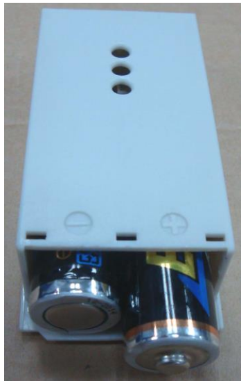
Figur 3-2 Sette batterier i batteriromdekselet
